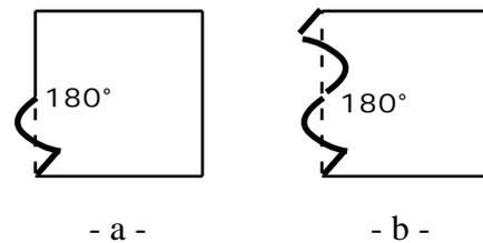
Figura 3. Deformación por giro de  $180^\circ$ .
