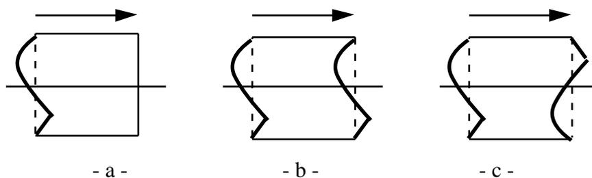
Figura 4. Deformación por simetría en deslizamiento.
